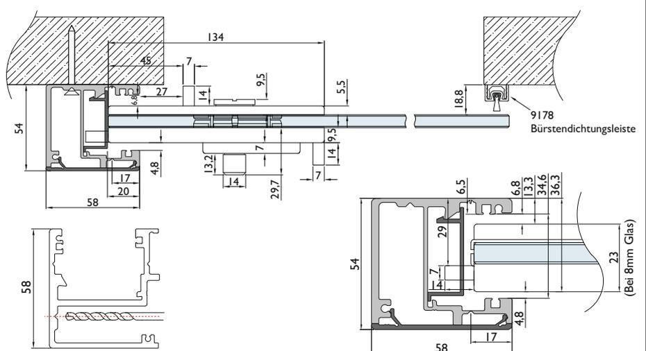
**⚠ Achtung** Schiene muss um die Breite des Anschlagprofils (58 mm) länger sein.
